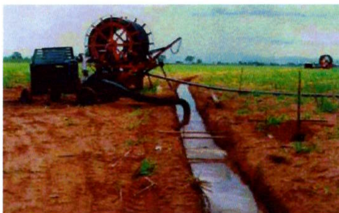
Figura 2.6 – Sistema com carretel enrolador com captação do canal. Fonte: DINIZ, 2010.
