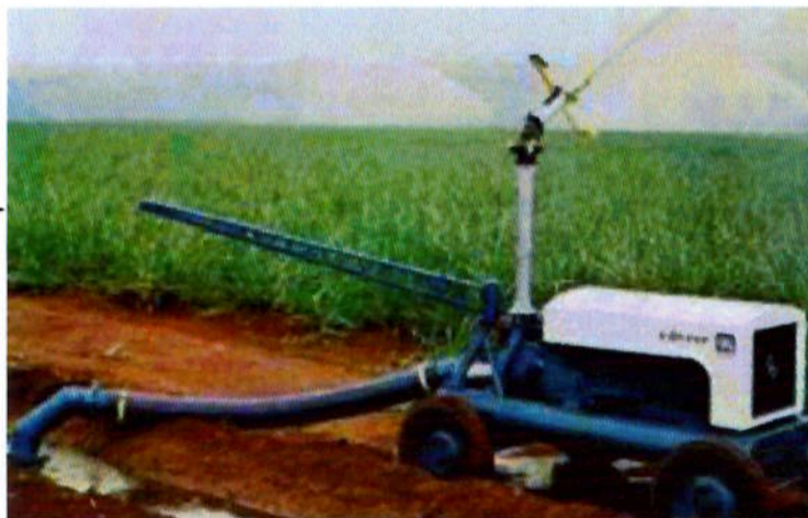
Figura 2.5 – Sistema de aspersão por montagem direta. Fonte: DINIZ, 2010.
