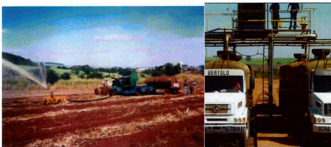
Figura 2.7 – Sistema de aplicação de vinhaça por caminhão Fonte: LUZ, P. C.H., DAMY, C. R. S., VIZZOTTO, B.A., 2008.
